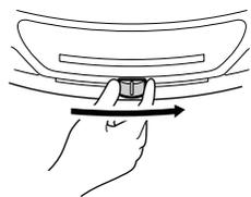
4 使用後は温度調節レバーを「切」にして、電源プラグをコンセントから抜き、マグネットプラグをマグネットプラグ差込口から抜く。
