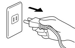
本体が十分に冷えてから、自動温度調節器を差込口から抜きます。
