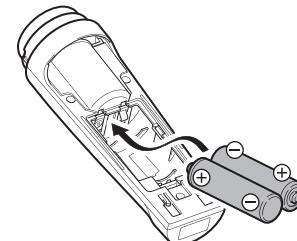
2 電池カバーを図のように押し上げて(①)外す(②)。
