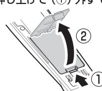
4 取り外しと逆の手順で、電池カバーとダストボックスを本体に取り付ける。
