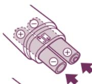
4 本体と電池カバーを持ち、電池カバーを取り付ける。
