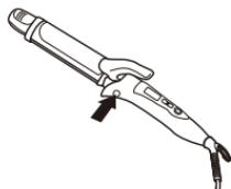
5秒間ボタン操作しないと、温度ロックされますので、温度調節操作ができなくなります。解除は、(→P.4) 4の解除方法によります。
