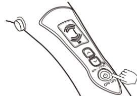
5秒間ボタン操作しないと、温度ロックされますので、温度調節操作ができなくなります。解除は、4の解除方法によります。
