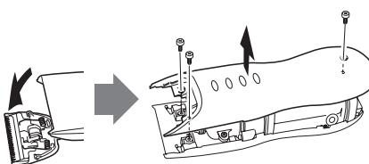
④スイッチカバーを取り除き、ネジ(4本)を外して、内部を引き抜く。
