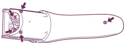
4 図の2ヶ所のネジを外して内部を引き抜き、スイッチカバーを取り除く。
