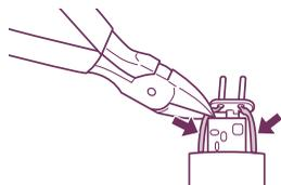
7 図のように、外したソケットケース側から押して、中の充電基板を引き出す。
