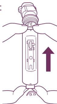
8 引き出した基板の図のリード線2本（赤・黒）をニッパーで切断し、バッテリーを切り離す。
