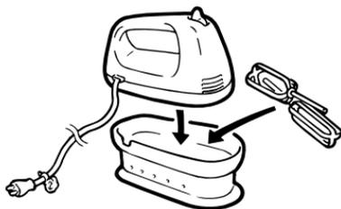
② コードを強く引っ張らないように収納ケースに巻き付け、巻き終わりのコードクリップ部分を側面の穴のいずれかに止めます。
