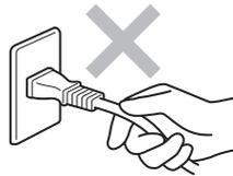
使用後は必ず電源スイッチを切り、電源プラグをコンセントから抜く。火災・感電・けがの恐れがあります。
