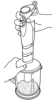
**7** 使用後は、電源プラグをコンセントから抜き、取り外しボタンを押して、本体を外す。
