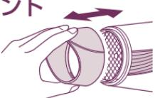
取り外しできます。フードと本体側面の模様がつながるように取り付けてください。
