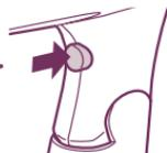
**3 使用後は、切替スイッチを「OFF」にし、電源プラグをコンセントから抜く。**
