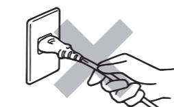
必ず守る コンセントから電源プラグを抜くときは、電源プラグを持って抜く。
