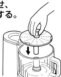
3 おろし刃の上に材料をのせ、ボトルフタをのせ、電源プラグをコンセントに差し込む。
