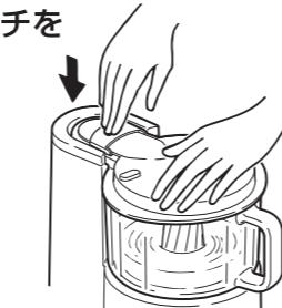
**必ず守る** 途中でフタを開けるときは、必ず電源プラグをコンセントから抜いてから開ける。
