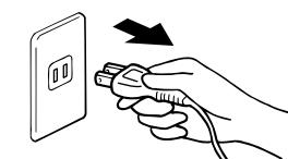
コンセントから電源プラグを抜く時は、電源プラグを持って抜く。
