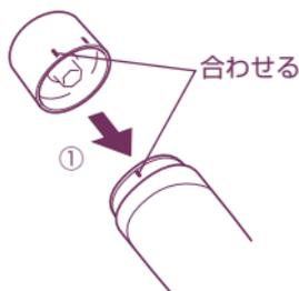
② アタッチメントの **■** 印（右側）が、本体の **■** 印に合うまで図の矢印方向に回し、本体に取り付ける。
