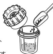
ミルパッキン、ミルボトル台、ミル安全装置リングが正しくセットされているか確認します。
