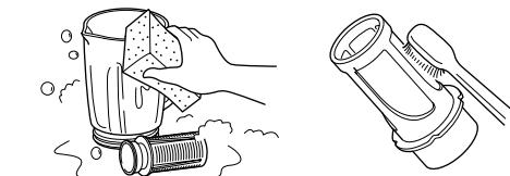
洗う前に、ミキサー部を組み立てた状態でぬるま湯を1/3入れ台所用洗剤を数滴加え動作させてから洗うと簡単です。
