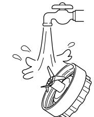
ミキサー部台・ミルボトル台裏面のゴムカブラーは、直接水をかけたり、つけ置き洗いをしないでください。
