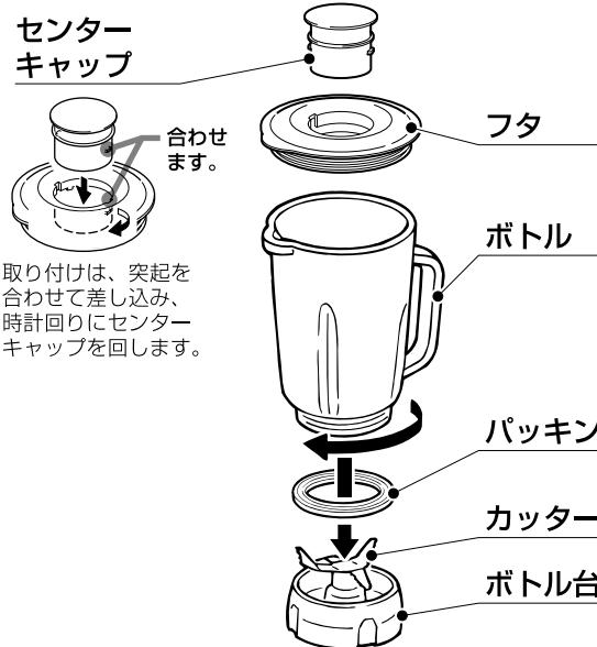
分解は、下図のようにボトル台を回してはずしてください。
