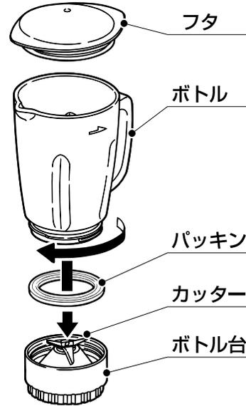
分解は、下図のようにボトル台を回してはずしてください。
