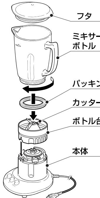
分解は、下図のようにボトル台を回してはずしてください。
