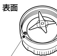
パッキンを取り付け、ミキサーボトルを取り付けると、裏面に押し出された状態になります。安全スイッチピンのまわりに食材を詰まらせないでください。(安全スイッチが正常に動作しなくなります。)
