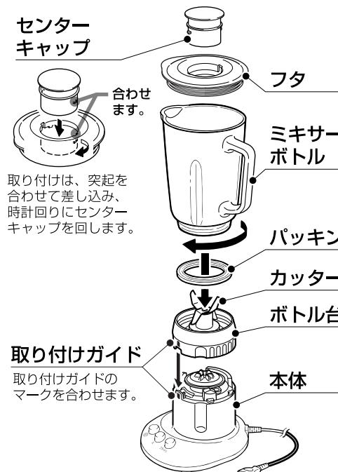
分解は、下図のようにボトル台を回してはずしてください。
