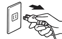
必ず運転が停止していることを確認してから電源プラグを抜く。
