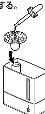
3 タンクキャップを外し、タンクに水を入れ本体にセットする。
