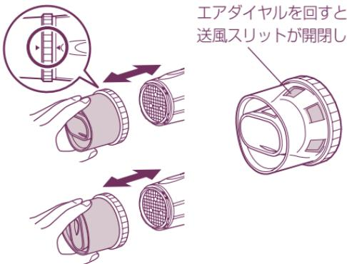
エアダイヤルを回すと、送風スリットが開閉します。
