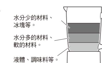
● 放入攪拌瓶的材料，含液體應高於最小刻度(300ml)，以及低於最大刻度(1000ml)。
