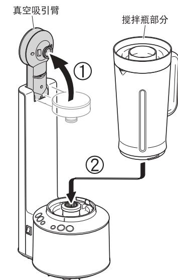
③如图示箭头方向旋转安装搅拌瓶部分。
