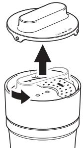
②按压释压开关的PUSH处，拿着翘起的另一侧拆除。
