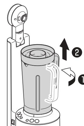
打开瓶盖时，请将搅拌瓶放置在稳定的场所，按住搅拌瓶，从把手上方的手指扣压处打开。
