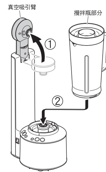
③依圖示箭頭方向旋轉安裝攪拌瓶部分。
