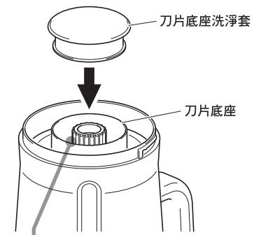
安裝刀頭座清洗用壓扣蓋時，請在刀頭座已置於攪拌瓶上的狀態下安裝。此外，拆卸清洗用壓扣蓋時，請小心拆卸避免觸碰刀刃。
