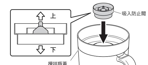
②由上而下確實蓋緊攪拌瓶壓扣蓋。
