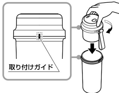
本体を回して、取り付けガイドが合うようにセットします。
