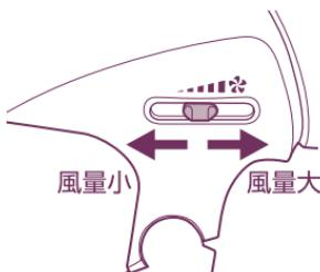
室温が低いときに HOT- 最大風量で使うと、温風の温度が通常より低く感じられる場合があります。風量を下げるとき温風の温度が上がりりますので、調節してお使いください。
