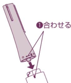
②うぶ毛用刃の印(■)が、本体の印(■)と合うまで図の矢印の方向に回す。
