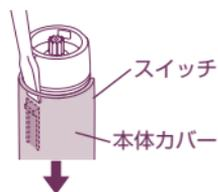
4 充電電池ホルダーの溝から爪楊枝などで押して、充電電池を取り出す。
