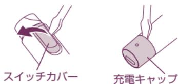
3 スイッチ裏面から本体と本体カバーのすき間にマイナスドライバーを差し込み、ツメを外し本体カバーを取り外す。
