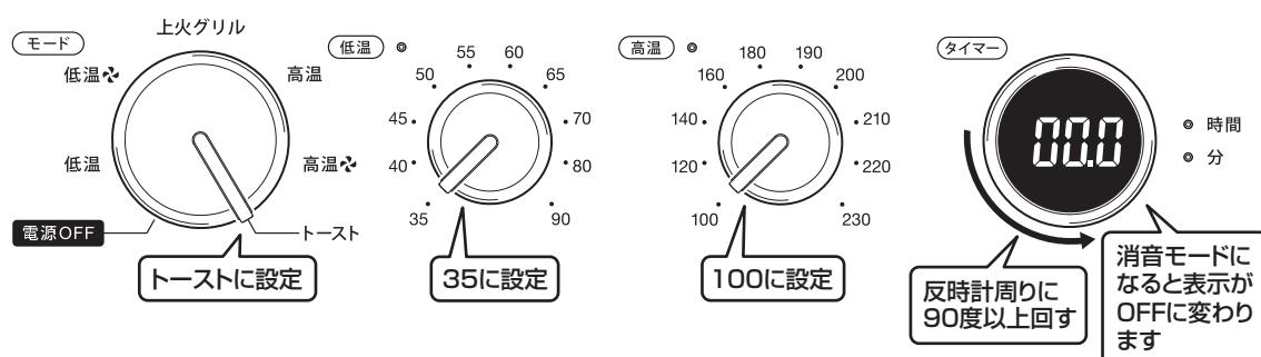
モード切替つまみ：トースト、温度設定つまみ「低温」：35、温度設定つまみ「高温」：100に設定し、タイマーフタリを反時計回りに90度以上回し、10秒以上放置してください。
