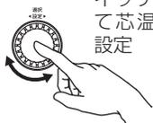
①ダイヤルスイッチを回して芯温温度を設定
