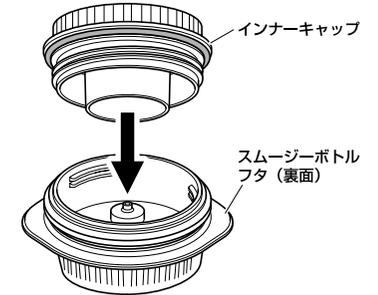
③インナーキャップを図の矢印の方向に回して取り付ける。
